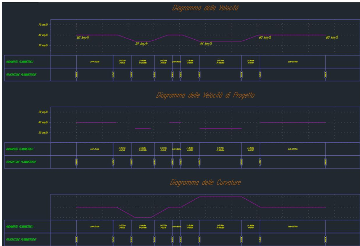
Se il tracciato non è compatibile con i vincoli di progettazione planimetrici il comando restituisce una schermata di errore portando a zero il valore della velocità.
