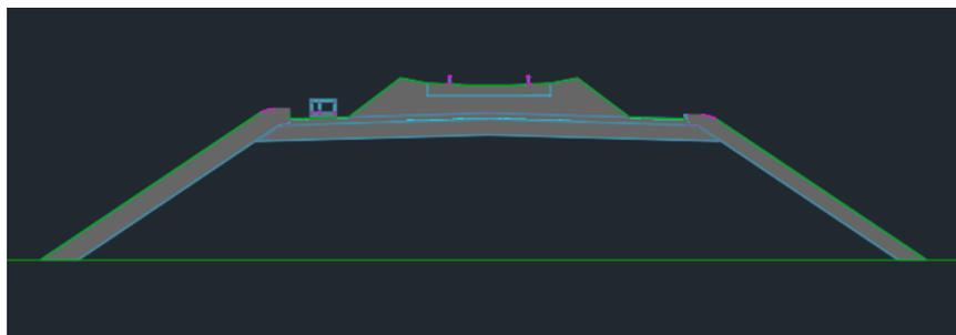
*Configurazione in rettilo – sezione in rilevato*
