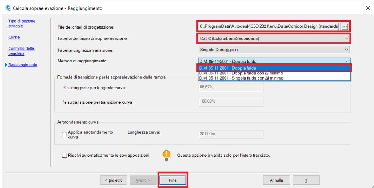
Cliccando su Fine viene calcolata la sopraelevazione per tutte le curve del tracciato. Per correggere il valore di sovrappendenza longitudinale nelle transizioni in cui non risulta soddisfatta la  $\Delta i_{min}$ , può essere usato il comando del Country KIT "Verifica Sopraelevazione".
