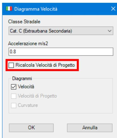
Inoltre, al Diagramma della velocità viene assegnato un insieme di controlli di progettazione (Design check set) per visualizzare eventuali errori relativi alla accelerazione/decelerazione massima ammissibile da normativa.
