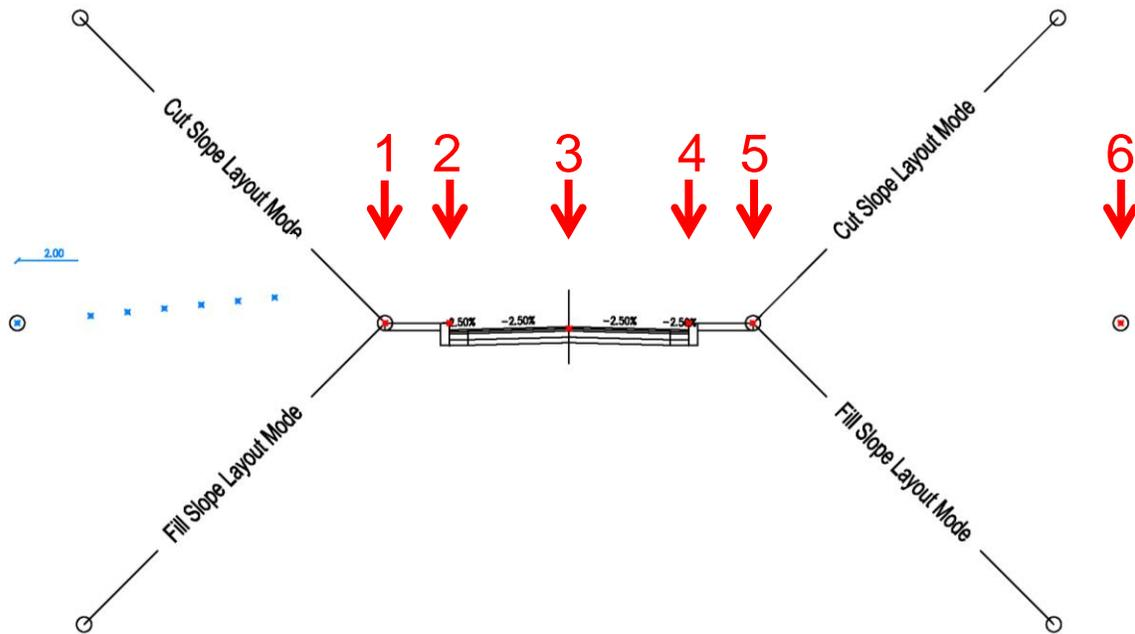
Ricostruendo quindi il modellatore (corridor) generato con la sezione tipo appena creata, nelle **Viste Sezioni**, si otterrà un risultato simile a quanto riportato di seguito.
