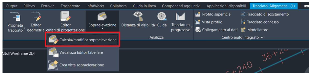
Nelle prime tre schede della finestra bisogna specificare la tipologia di sezione stradale, la larghezza delle corsie e quella delle banchine.
