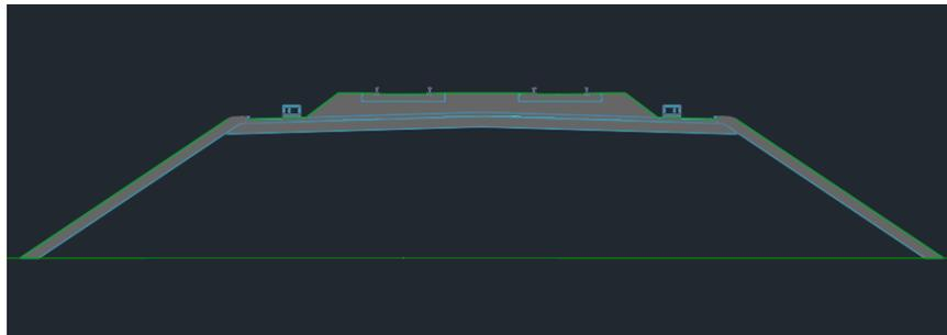
*Configurazione in rettilo – sezione in rilevato*
