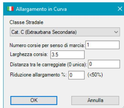
Cliccando su "OK" vengono generate delle polilinee lungo il tracciato per tutto lo sviluppo dell'allargamento. Le polilinee create vengono associate a dei layer in funzione della loro posizione rispetto l'asse del tracciato.
