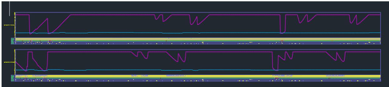
Selezionando nella finestra l'opzione "Calcola allargamento" verranno realizzate delle polilinee lungo il tracciato nelle aree in cui deve essere previsto un allargamento della carreggiata. Esse rappresentano quindi l'andamento del bordo esterno della banchina in destra (o della corsia di emergenza, a seconda del calibro stradale) per garantire la visibilità sul tracciato.
