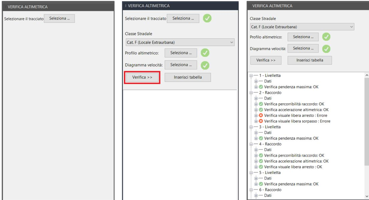
Cliccando sul pulsante “Verifica >>”, nello spazio sottostante compare la struttura ad albero del profilo dove, per ogni entità (livelletta, raccodo parabolico simmetrico, raccordo circolare) vengono indicati i dati associati, i limiti da normativa dipendenti da elemento e classe stradale, e il superamento o meno di tali verifiche.
