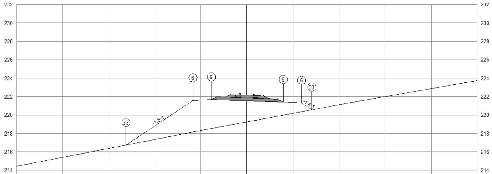
A numeração dos pontos dos vértices das seções transversais poderá ser personalizada através dos estilos de **Code Set Styles**, digitando a numeração desejada na coluna **Description** e adicionando o estilo de Label na coluna **Label Style** do código de **Point**.
