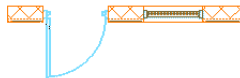
représentations d'affichage du plan pour murs, portes et fenêtres en 2D depuis une direction de la vue en plan
