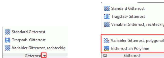
Abbildung 16: Zusätzliche Rasterbefehle öffnen
