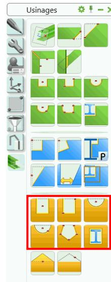
Figure 80 : Palette **Usinages** - Outils de traitement indépendants du SCU
