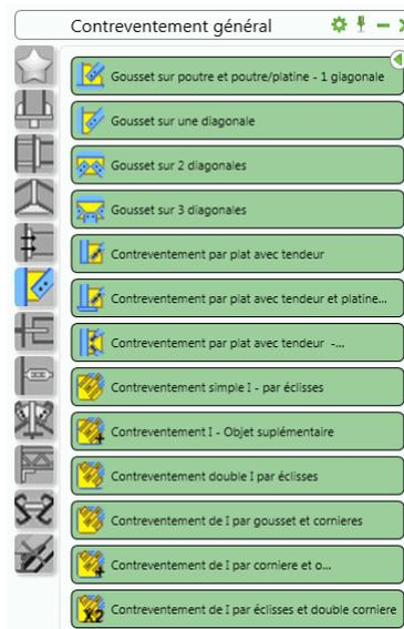
Figure 134 : Catégorie **Assemblages de contreventement par gousset**
