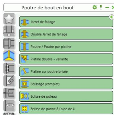
Figure 129 : Catégorie **Assemblage poutre - poutre**
