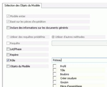
Figure 189 : Fenêtre de sélection des objets du modèle pour la création d'une liste
