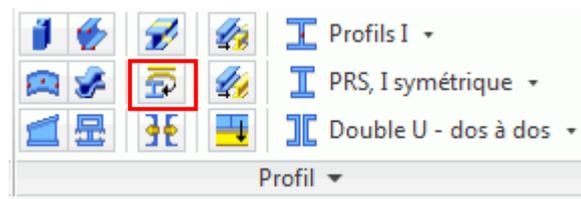
Figure 39 : Groupe de fonctions poutre-poutre à partir de ligne
