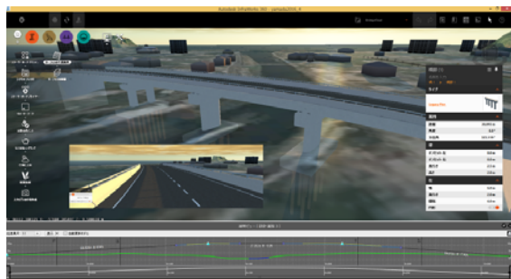
Autodesk InfraWorks 360 道路、橋梁、排水の設計を統合した 機能の画面イメージ
