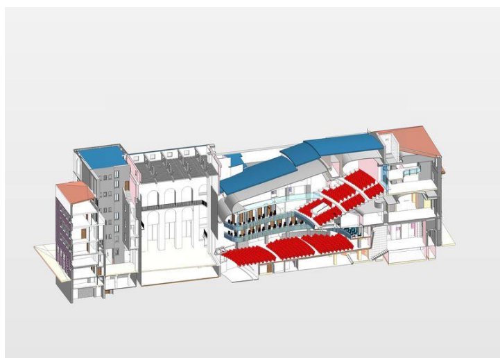
レーザー スキャン データから作成した劇場の3Dモデル (画像はミラノ市提供)
