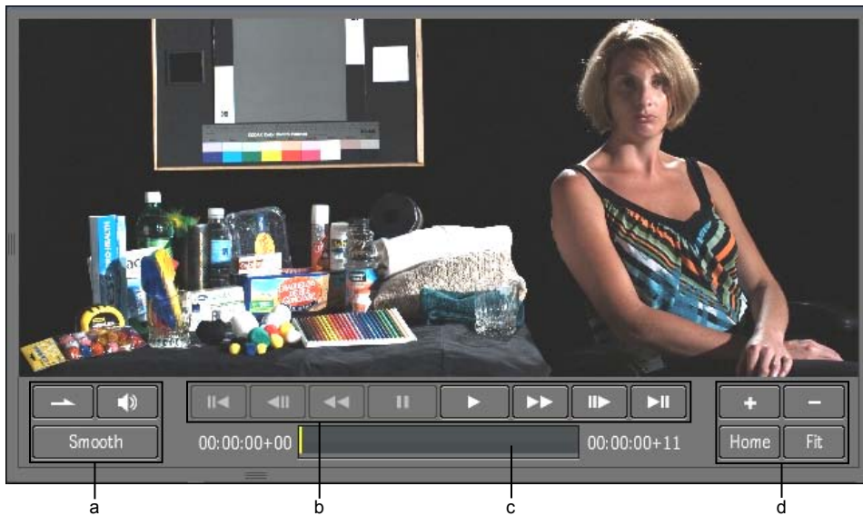
(a) Loop/mute/smooth display (b) Playback controls (c) Time bar (d) Zoom controls
