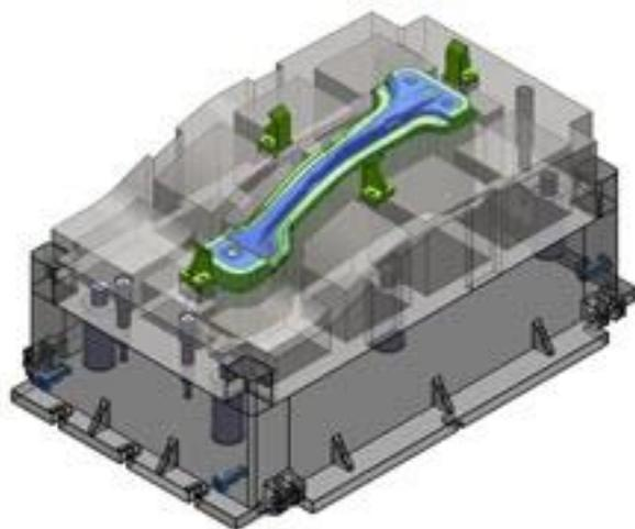
PowerShape combina las fortalezas de las superficies, los sólidos y las mallas en un paquete de herramientas dirigido a los fabricantes de moldes, de postizos y de, en general, piezas con un alto grado de complejidad. PowerShape se puede utilizar para diseñar productos desde cero.
