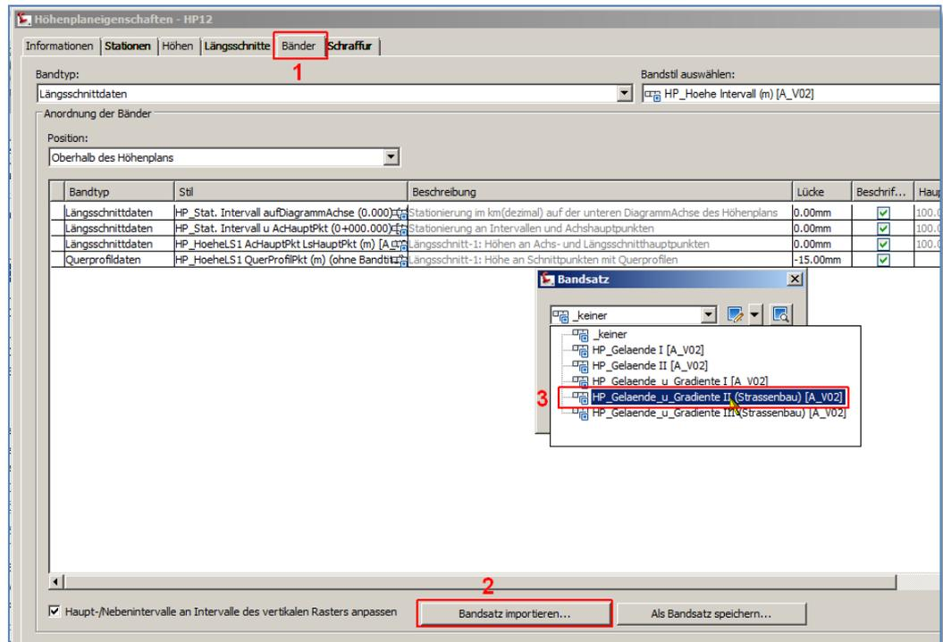
Die Anzahl der Bänder wird dabei verständlicherweise länger. Wichtig sind in erster Linie die Spalten "**Längsschnitt 1**", "**Längsschnitt 2**" und, wenn Querprofile vorhanden, die Spalte "**Datenquelle**". In diesen Spalten wird für Höhenpläne mit mehreren Längsschnitten angegeben, welche Daten entsprechend für Anzeigen wie z.B. Höhen heranzuziehen sind.
