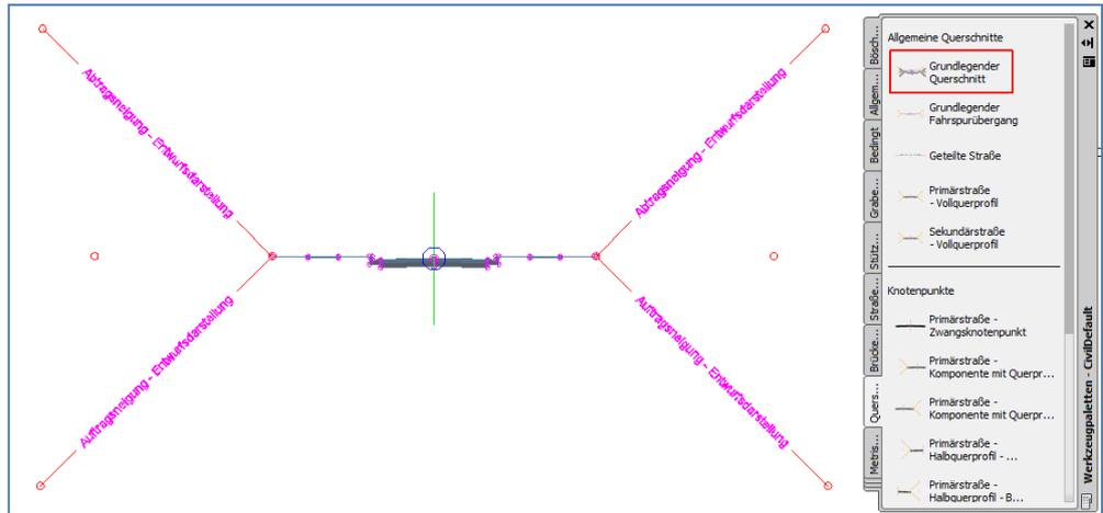
Breiten der einzelnen Querschnittsbestandteile, Neigungen für die Anschlüsse etc. sind durch Aktivieren des Bestandteils und Modifizieren des entsprechenden Wertes im AutoCAD-Eigenschaftsfenster durchzuführen.
