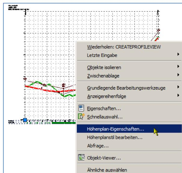
Wechseln Sie im Höhenplan-Eigenschaften-Dialog auf die Karte "*Informationen*", der Objektstil (der Höhenplanstil) wird auf "*HP\_Gelaende+Gradiente Strassenbau detailliert 10xUE [A\_V02]*" eingestellt. Damit werden Rastereinstellungen, Beschriftungstexte (Diagramm-Achsen-Beschriftung) geregelt.
