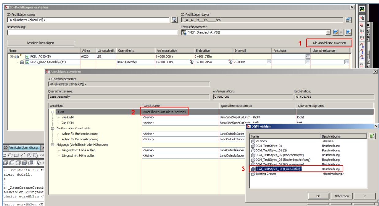
Die Anzeigenart des Profilkörpers wird ebenfalls mittels der Codes definiert, selektieren Sie dazu den **Profilkörper** → **rechte Maustaste** → **3D-Profilkörper-Eigenschaften**.
