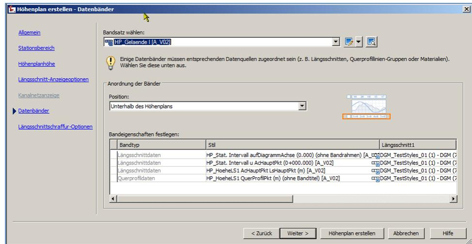
Da keine Schraffuren für Schichten auf der nächsten Seite des Wizards definiert werden, kann die Erstellung des Höhenplans mit dem Button "*Höhenplan erstellen*" fortgesetzt werden.
