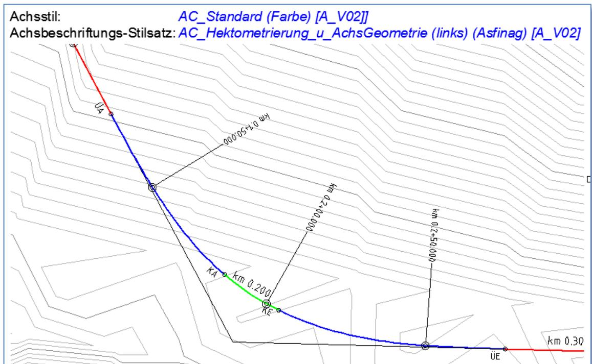
Hinweis zu Achserstellung aus Geometrieobjekten: nach Zeigen des Geometrieelements folgt (mit einem Pfeil in der Graphik als Voransicht) die Abfrage nach der Richtung des Achsverlaufs. Die Eingabe der angebotene Option "Umkehren" ist derzeit nicht mit "U" möglich, es funktioniert mit der englischen Eingabe "R" (bitte auf das führende Underline bei der Eingabe achten) für "reverse".
