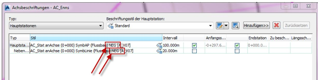
Für alle davon abgeleiteten Darstellungen wie Achsbeschriftung, Höhenplan samt Bändern, Querprofilpläne sind in der Vorlagenzeichnung eben solche Stile (...NEG...) definiert, um die negativen Stationierungen positiv darzustellen.
