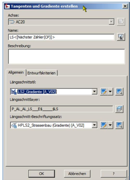
Stile (und Teile des Layernamens) für Gradienten sind i.d.R. mit der Abkürzung "*LS2*" versehen, die des Geländes (Urgeländes) mit "*LS1*".
