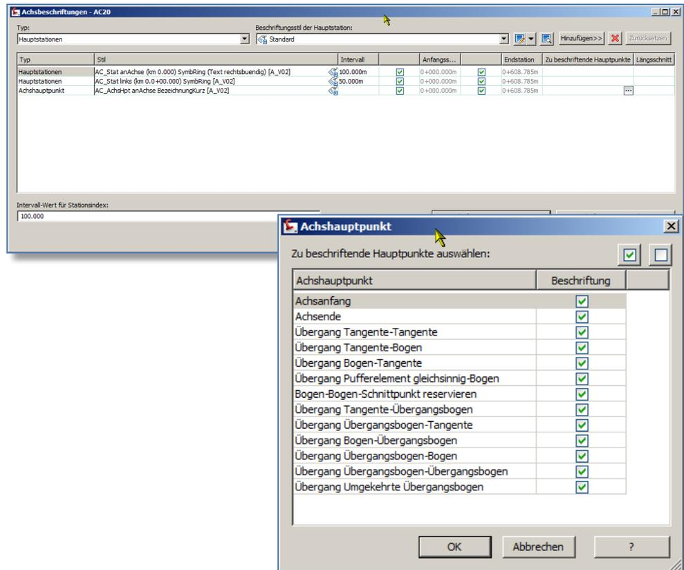
Mit "[Beschriftungssatz importieren](#)" kann jederzeit auf einen anderen bestehenden Beschriftungssatz umgestellt werden. Alternativ kann im gleichen Dialog oben "[Typ](#)" und "[Beschriftungsstil](#)" gewählt und mittels "[Hinzufügen](#)" zu der Liste der vorhandenen Beschriftungen angefügt werden.
