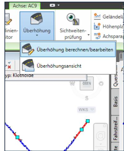
Im folgenden Dialog wählen Sie Überhöhungen jetzt berechnen, damit wird ein Wizard gestartet, der Sie durch die Definition der Bestandteile leitet.
