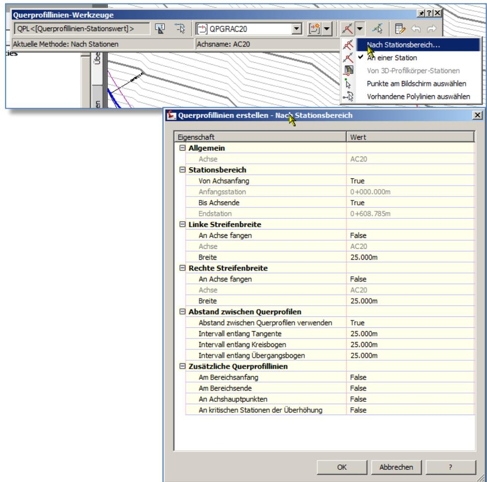
In dem Folgedialog werden die Intervalle eingestellt und, bei Bedarf, Querprofilinien an markanten Achspunkten.
