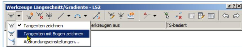
Starten Sie die Zeichnungsfunktion mittels "*Tangenten mit Bögen zeichnen*" und zeigen Sie die einzelnen Punkte (vergleichbar mit der Zeichnungsfunktion einer Polylinie) im Höhenplan.
